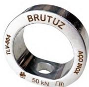
Dispositivo de ancoragem tipo A1/C, com capacidade de resistir esforços de até 5.000kgf ou 50kN, para até duas pessoas. Para ancoragem de múltiplos mosquetões ou cabos de aço. Robusto e com design inovador, não possui cantos vivos.
