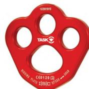
Placa multiplicadora de ancoragens feita em alumínio de alta resistência e durabilidade. Seu formato 1:3 distribui 1 ponto de conexão para outros 3 durante manobras verticais ou em espaços confinados. Resistência: 36kN. Peso: 58g
