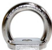
Dispositivo de ancoragem do tipo A, construído em aço inoxidável, com resistência de 34kN, para uso em trabalhos em altura, espaços confinados, linhas de vida, acessos por corda e operações de resgate.
