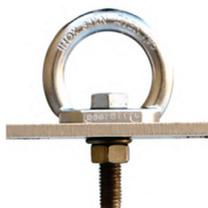
Dispositivo de ancoragem do tipo "A", construído em aço inoxidável, com resistência de 34kN, com parafuso 12mm.
