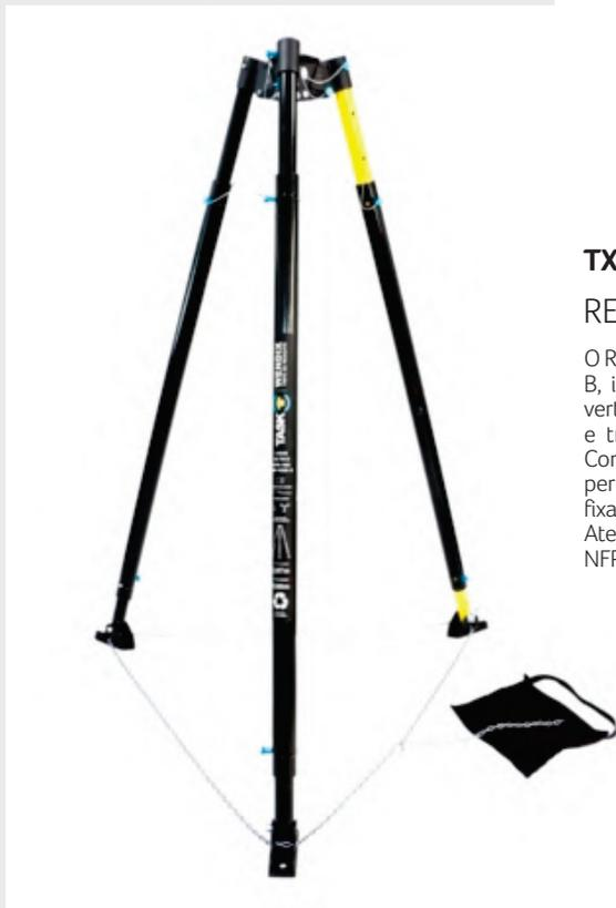
O SISTEMA WENDIX é um dispositivo de ancoragem transportável do tipo B, projetado para trabalhos e resgates em locais de difícil acesso, suportando até duas pessoas. Versátil, pode ser configurado como tripé, bipé ou monopé, adaptando-se a diferentes cenários. Fabricado com cabeçote, patas e roseta em aço e patas em liga de alumínio aeronáutico, oferece alta resistência e confiabilidade. Atende às normas NBR 16325-1.B, EN 795B e NFPA 1983.
