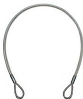
Cabo de ancoragem 5/16" (8mm) em aço inox, com olhais nas pontas e proteção do cabo em PVC. Resistência: 25 kN. Tamanho: 1m, 1,20m e 1,6m. Peso: 1m 400 | 1,2m 600g | 1,6m 800g
